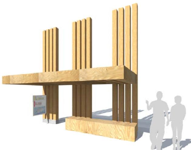
Aubette est basé sur des lignes verticales fortes semblables aux poteaux et sur une toiture en porte-à-faux. Les objectifs de simplicité et d'accessibilité déterminent le projet.
