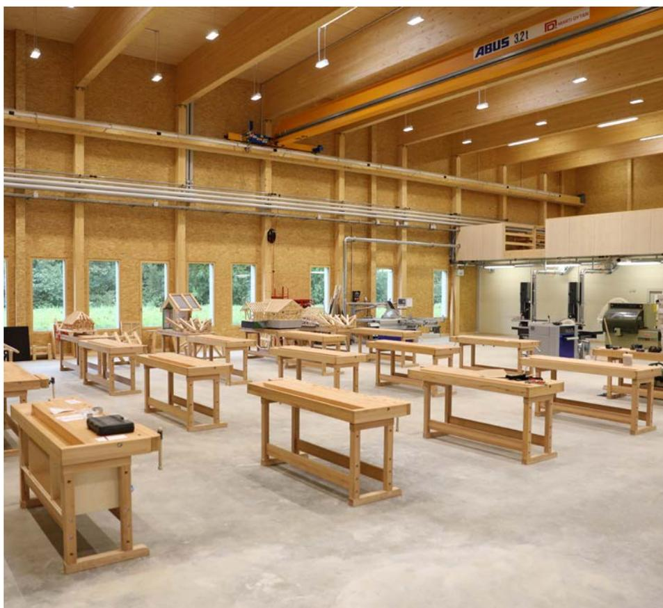
vert de panneaux acoustiques. Les alimentations techniques, adaptées, sont reprises depuis l'EJB 1: chauffage, électricité, eau, air comprimé. Seule l'aspiration des poussières se fait par une installation individuelle supplémentaire. Les eaux pluviales du toit et du parking sont récupérées et infiltrées dans un bassin à ciel ouvert situé à l'est du bâtiment.
