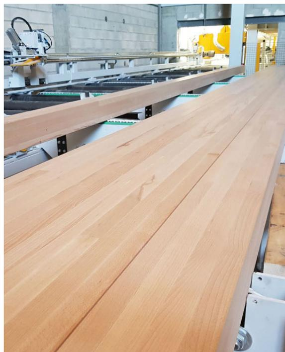
Aux Breuleux (JU), l'usine de Fagus Suisse SA complètement rééquipée, est aujourd'hui entièrement adaptée au nouveau procédé. Les derniers ajustements ont été effectués et la production est en cours, permettant de transformer le bois de hêtre de la région en bois lamellé-collé (BLM) de haute qualité. Sa valeur ajoutée est multipliée par rapport à l'exportation habituelle, sous forme de bois d'ameublement.
