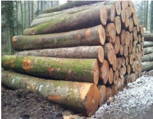
Fissures et torsions dues aux tensions internes
